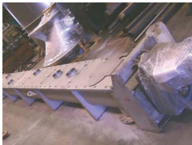
Installation d'une vis d'Archimède dans l'industrie plastique
