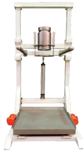
Station de remplissage de Big Bag avec mise en extension
