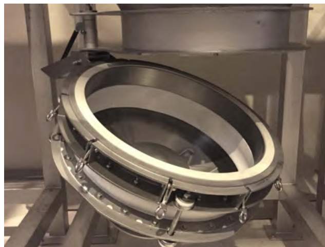
Installation d'un fond vibrant dans l'industrie plastique
