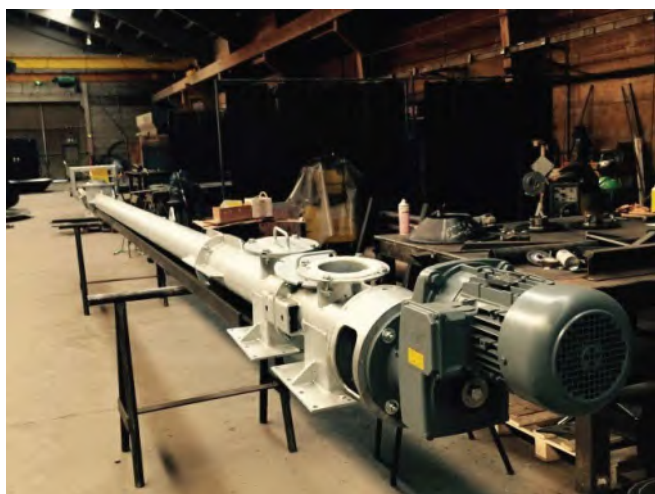
Installation d'une vis d'Archimède dans le domaine du transport maritime
